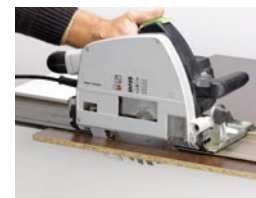
Türfüllung zuschneiden. Die Schnittkanten sind nach dem Zusammenbau unsichtbar!
